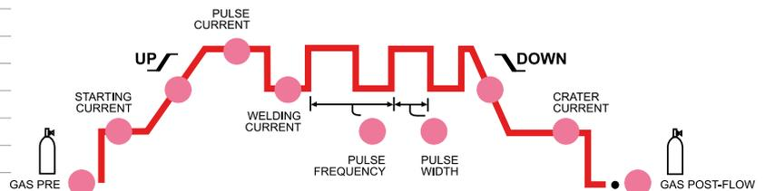
Équipement de soudage TIG, pour une utilisation sévère de qualité maximale de tous les types d'aciers au carbone, aciers inoxydables, titane et alliages et contrôle des ondes pulsées. Convient pour une utilisation avec une électrode enrobée jusqu'à 200 ampères.
